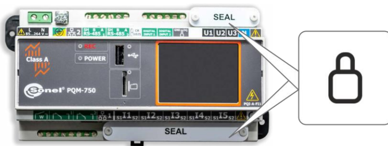
Rys. 7. Plombowanie wejść pomiarowych.
